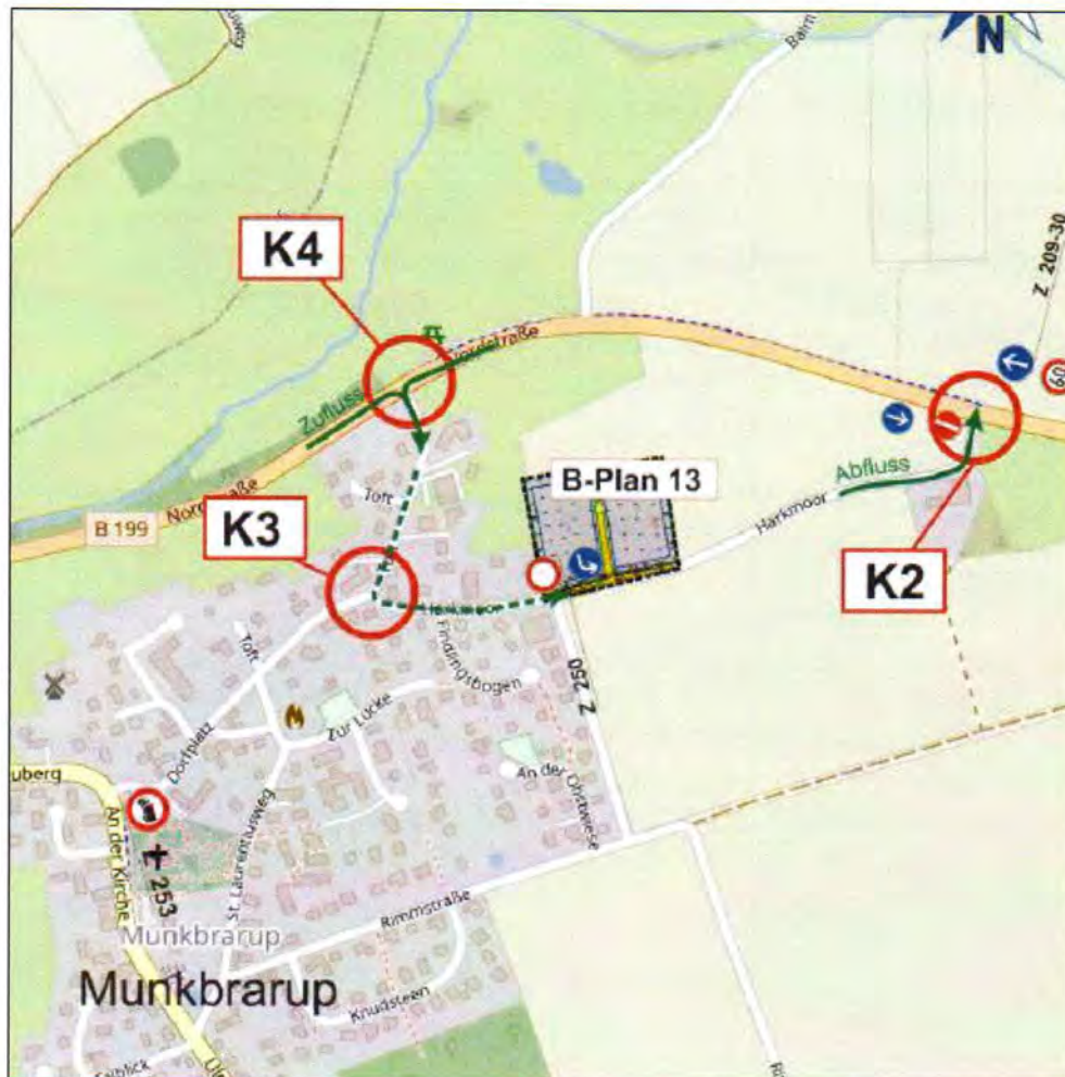
Abb. 8: Skizze zur Verkehrsführung (Zu- und Abfluss) zum Gewerbegebiet
